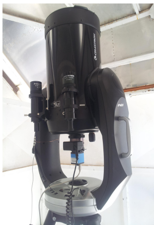
Figura 1: Telescopio Celestron empleado para medir seeing en el CASLEO.
