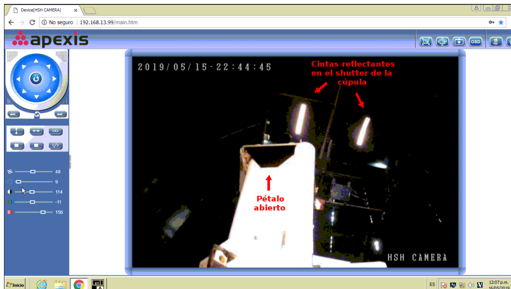
Fig 16. Cintas en el shutter de la cúpula indicando que éste se encuentra cerrado.
