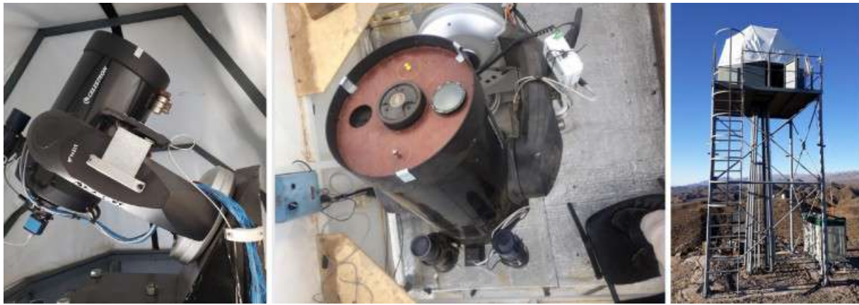
Fig. 5. imágenes del telescopio Celestron 11" con máscara de dos aperturas, una de ellas con cuña, y de la torre que alberga al mismo.
